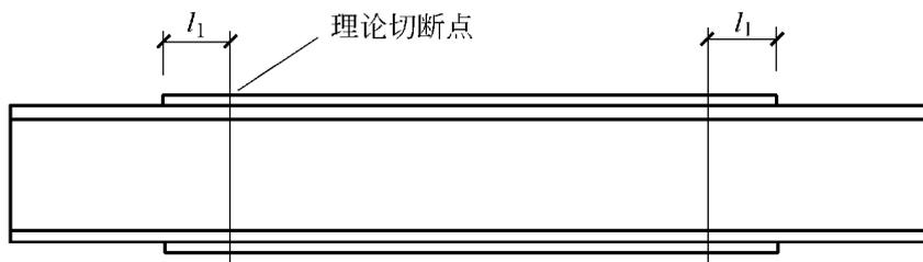
图 5.4.5 翼缘板切断点
