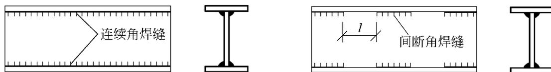
图 3.1.6 连续角焊缝和间断角焊缝
